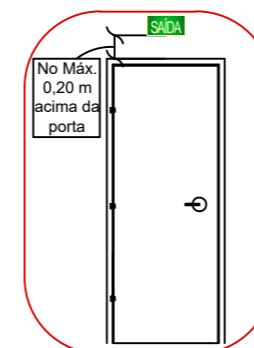
DETALHE SINALIZAÇÃO DE SAÍDA ACIMA DA PORTA
